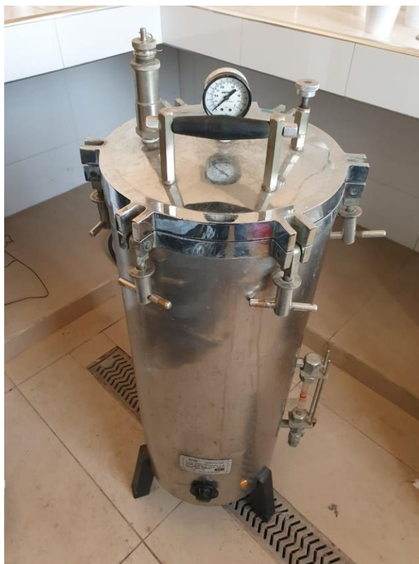
Figura 6. Autoclave utilizada para esterilizar los materiales de laboratorio.
